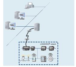
Le unità XENTA 511 e XENTA 911 integrano la funzione LonTalk Adapter (LTA) e possono essere quindi utilizzate per collegare TAC VISTA® IV ad una rete LonWorks.
